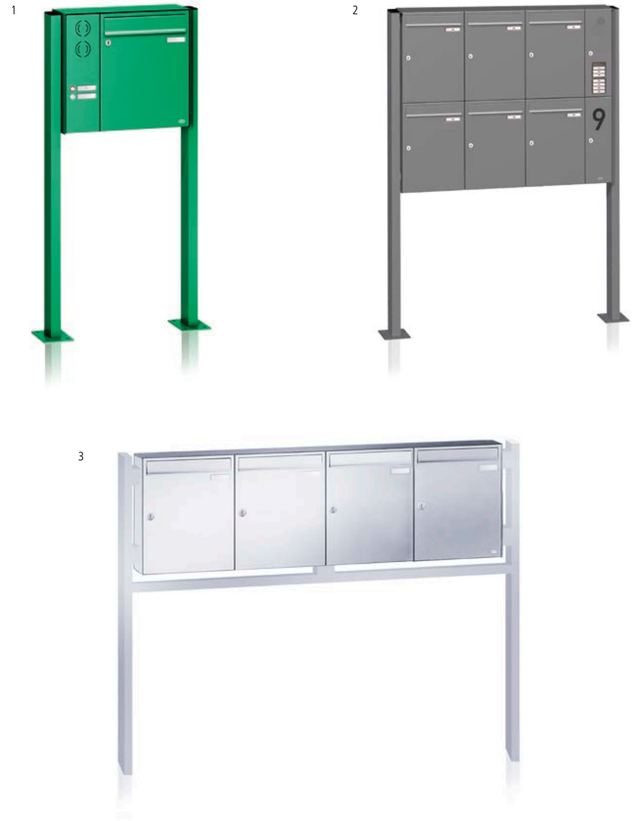
Abb. 1 Freistehende Anlage mit Verkleidung BASIC (A) 3-seitig, Rechteckrohrständer 80 x 40 mm mit Fußplatten zum Aufschrauben, Standard-Zeitungsklappe, Schrägeinwurf RS50, RSA2-Klingelsystem und Namensschild. Abb. 2 Freistehende Anlage mit Verkleidung BASIC (A) 3-seitig, Rechteckrohrständer 80 x 40 mm mit Fußplatten zum Aufschrauben, Standard-Einwurfklappe, RSA1-Sprechfeld, Kunststoff-Klingelmodul und Namensschild, farbig ausgelegte Eingravur. Abb. 3 Freistehende Anlage mit Verkleidung BASIC (A) 3-seitig aus Edelstahl V4A, Rechteckrohrständer 80 x 40 mm aus Edelstahl V4A mit Quertraverse zum Einbetonieren, geräuschgedämpfte und wasserabweisende Einwurfklappe RSK, RSA2-Namensschild.
